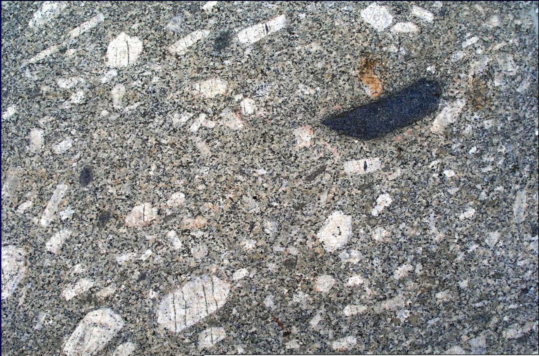
Параллельные текстуры течения в гранитах, выраженные в ориентировке фенокристов полевого шпата и ксенолитов габбро. Облицовка подъезда Главного Здания МГУ.
