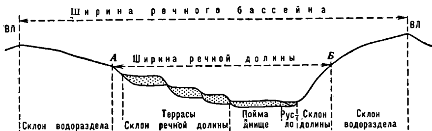
Рис. 21. Поперечный разрез бассейна и долины реки. ВЛ — водораздельная линия
