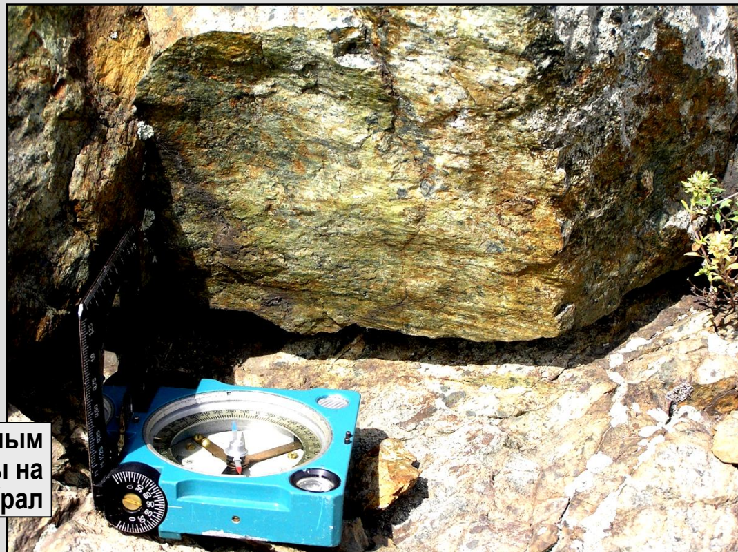
Штриховка на зеркале при сдвиге
