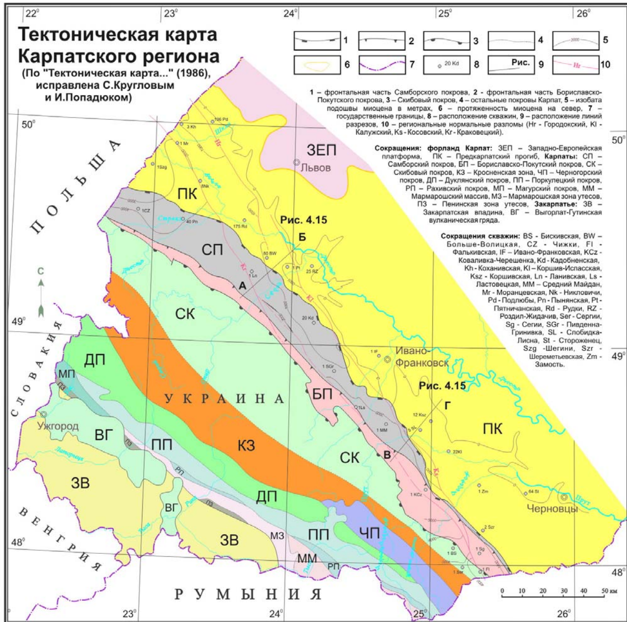
Рис. 4.13. Тектоническая карта Карпатского региона (с обозначением положения региональных геологических разрезов через Предкарпатский прогиб).
