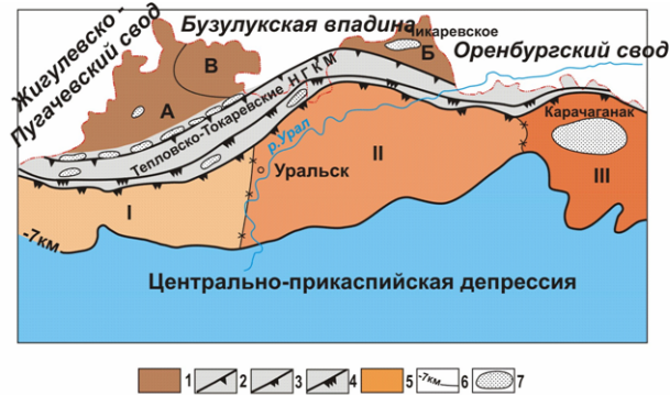
Схема структурно-тектонического (нефтегазогеологического) районирования ( по С.М. Камалову и др., 1991г.) 1 - внешняя прибортовая часть ( А - Карловский, Б - Чинаревский выступы фундамента, В - Погодаево-Остафьевский прогиб; 2-4 зона бортовых уступов (2 - московско-артинский, 3 - визейско-башкирский, 4 - франко-турнейский); 5 - внутренняя прибортовая часть с зонами поднятий: I - Кузнецовско-Кушумская II - Федоровская, III - Карачаганак-Кобландинская; 6 - изогипсы поверхности подсольевых отложений; 7 - контуры основных месторождений.
